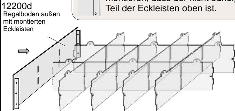
Die beiden fertig montierten Regalböden ( außen ) 12200d, werden nun an die Seitenwände 12200b gesteckt und mittels Schrauben und Muttern ( M3 ) fixiert.
