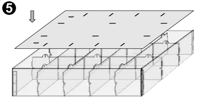
Abschließend wird die Rückwand 12200a aufgelegt und mittels Keilen fixiert. Sollen mehrere Regale nebeneinander aufgestellt werden, können Sie mit Hilfe der längeren M3 Schrauben verbunden werden.
