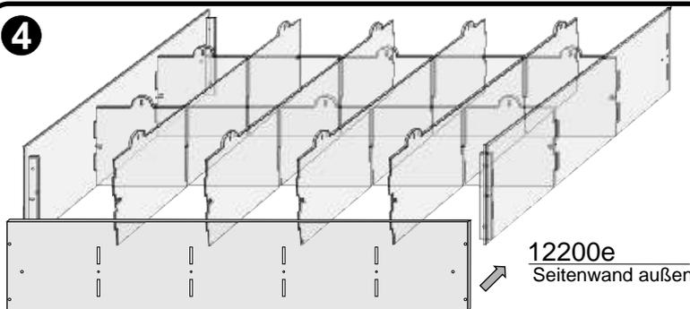
Jetzt werden die beiden Seitenwände ( außen ) 12200e befestigt und zusätzlich an den Eckleisten verschraubt.
