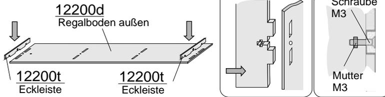
Die Eckleisten 12200t werden in den Regalböden 12200d gesteckt und mittels Schrauben und Muttern ( M3 ) fixiert. ( alle Schrauben bitte nur leicht anziehen )
