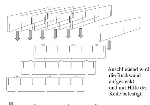
Vor der Montage zuerst die Schutzfolie entfernen.(beidseitig) Danach werden die Regalböden in die Regalseiten eingeschoben.
